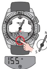
O ponteiro dos minutos aponta para Norte; o visor LCD indica o azimute
