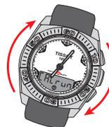
Rodar o relógio sobre si próprio mais de uma volta completa, num plano horizontal (por exemplo, em cima de uma mesa), num local sem perturbações magnéticas e com uma velocidade de rotação de, aproximadamente, 30° por segundo. Duração total: 20 segundos, no máximo
