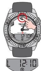
O visor exibe as horas das próximas marés alta e baixa
