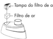
Remova a tampa do filtro de ar com uma haste fina e resistente que não quebre facilmente.
