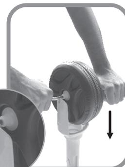
2- Apóie o garfo em uma superfície plana, forrada e firme, pressione o conjunto contra a extremidade de encaixe do garfo até o seu total encaixe.
