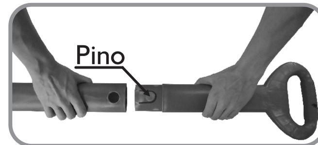
1- Encaixe a haste superior alinhando o pino no orifício da haste inferior e pressione até seu total encaixe.
