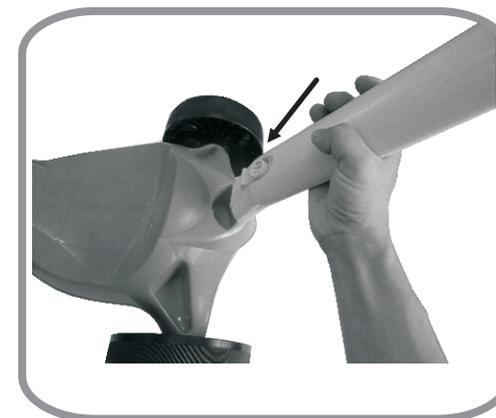
2- Para a montagem do conjunto da haste no corpo, retire a tampa do corpo com a ajuda de uma chave de fenda (Não inclusa). Introduza o conjunto da haste no orifício do corpo pressionando até o total encaixe.
