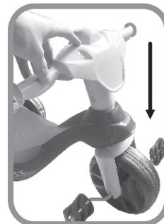
4- Posicione o guidão na extremidade do garfo e pressione até total travamento do conjunto. Observe que o pino do garfo deve encaixar no furo do guidão.
