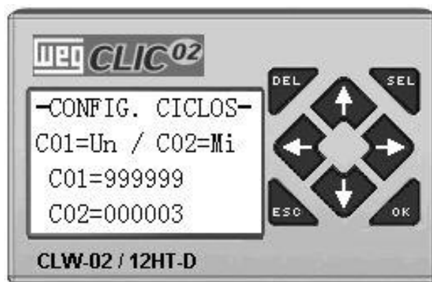
Figura 10 - Tela 04 – define a configuração do numero de ciclos que a Cicladora irá realizar
