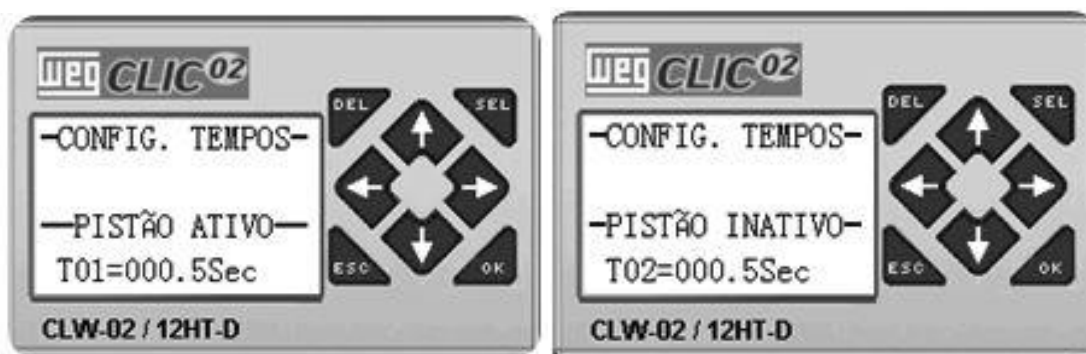
Figura 9 - Telas 02 e 03 – Define o ajuste do tempo de acionamento e recuo dos pistões
