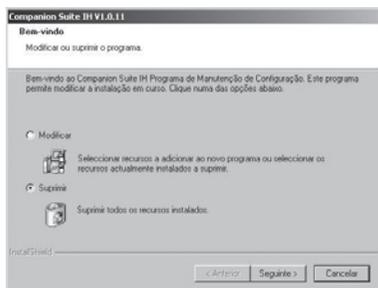
É-lhe pedido que confirme a desinstalação. Depois de ter clicado em OK, o software COMPANION SUITE IH é removido do computador. Terminada a desinstalação tem de reiniciar o computador. Desligue o aparelho multifuncional do computador **antes de o reiniciar**.
