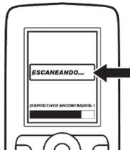
Se houver falha, repita o escaneamento novamente como mencionado acima ou consulte o manual do celular para ativação da função bluetooth®/viva-voz. Selecione a opção **FIAT CONNECT** e em seguida, confirme a pergunta no autorrádio **PAIR TO "Nome do celular<sup>(3)</sup>"?** Poderá ser apresentado a opção "YES" ou "NO". Para confirmar a pergunta no autorrádio, selecione a opção "YES" girando o botão rotativo no sentido horário e, em seguida, pres-
