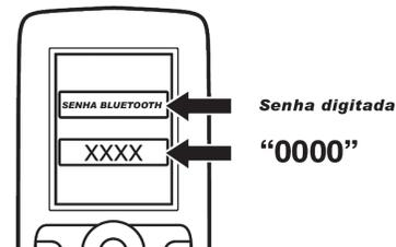
Seu celular estará vinculado (conectado) com o autorrádio em até dez metros de distância. Após a confirmação aparecerá brevemente no display do autorrádio **PAIRED TO “Nome do celular<sup>(3)</sup>”,** em seguida **CONNECTED TO “Nome do celular<sup>(3)</sup>”.**
