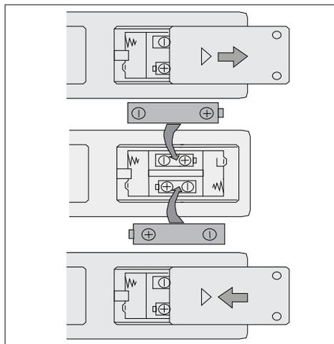
Abra e retire a tampa do compartimento de pilhas do controle remoto, coloque 2 pilhas AAA observando a polaridade (+ e -) indicada dentro do compartimento e recoloca a tampa.
