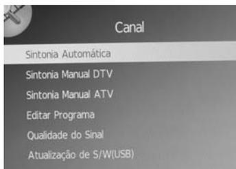
**Sintonia Automática** – se houver antenas AR e Cabo conectadas, nas respectivas tomadas, a programação de canais terá início pelos canais via AR e depois os canais a Cabo. Esta programação demora alguns minutos.
