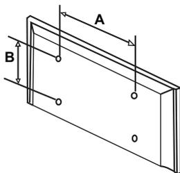
Instale o suporte em uma parede sólida e perpendicular ao chão.
