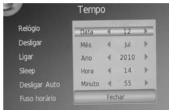
Os ajustes a seguir fazem parte do temporizador e podem ser ajustados para ligar e desligar o aparelho em horários predeterminados, no canal desejado e também com ajuste de volume.
