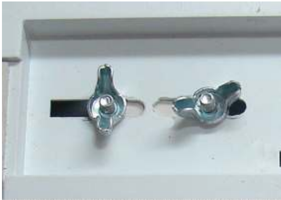
PARAFUSOS BORBOLETAS PARA REGULAGEM DA POSIÇÃO DO REBOLO Localizados embaixo do aparelho.
