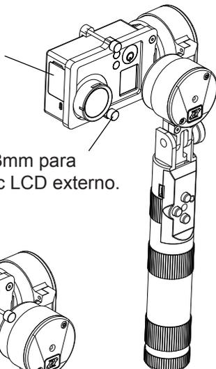
Utilize parafuso M2x23mm para instalação sem BacPac LCD externo.
