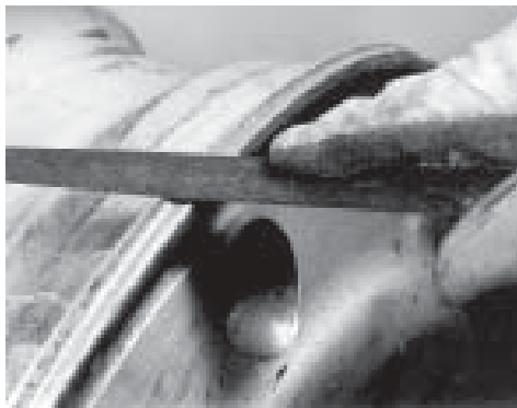
Foto 4. Removendo borda afiada manualmente usando uma lima de metal.
