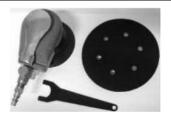
Após realizada a substituição, posicione o disco firmemente para que não solte quando a lixadeira estiver em uso.
