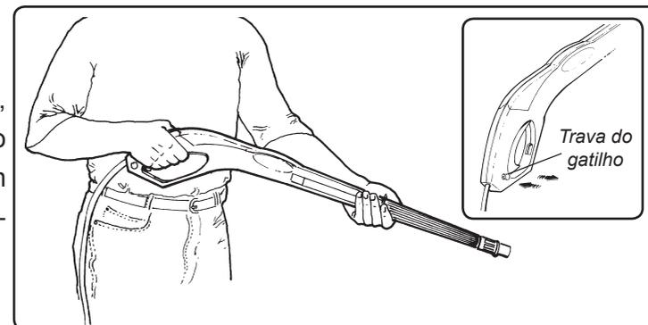
**NOTA:** Antes de iniciar o trabalho é necessário manter acionada a alavanca do gatilho para evitar sobrecargas no motor. Ao ligar a máquina, ocorrerá uma força de reação no gatilho, portanto, segure firmemente a pistola.
