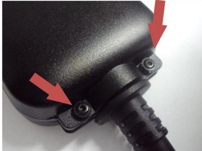
2. Com o auxílio de uma palheta ou um pequeno objeto plástico, deve-se fazer um esforço mecânico para destacar a tampa superior;
