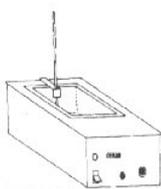
equipamento utilizado para aquecimento e incubação de líquidos a temperaturas inferiores a 100°C.
