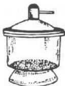
Usado no armazenamento de substâncias que devem ser mantidas sob pressão reduzida ou em condições de umidade baixa.
