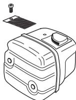
El silenciador está diseñado para amortiguar el ruido y para apartar del usuario los gases de escape. Los gases de escape están calientes y pueden contener chispas que pueden ocasionar incendios si se dirigen los gases a materiales secos e inflamables.
