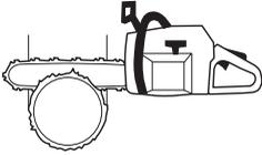
Há métodos para abate de árvores com os diâmetros do tronco maiores do que o comprimento da lâmina. Esses métodos acarretam o grande perigo de que o sector de risco de retrocesso da lâmina entre em contacto com algum objecto.
