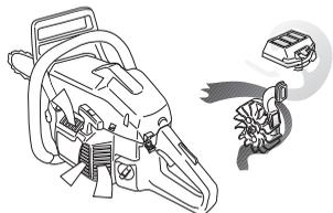
**IMPORTANTE!** Para conservar a função de purificação centrífuga, é necessário prestar assistência e manutenção contínuas. Limpe a entrada de ar do dispositivo de arranque, asas de ventoinha da cambota, compartimento em torno da cambota, tubo de admissão e compartimento do carburador.
