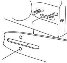
Tense la cadena enroscando en el sentido de las agujas del reloj el tornillo de tensado con la llave combinada. La cadena debe tensarse hasta que deje de colgar en la parte inferior de la espada. Vea las instrucciones del capítulo Tensado de la cadena de sierra.
