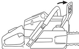
**Ignição:** Mova o contacto de paragem para a esquerda.
