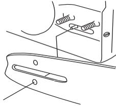
Estique a corrente, apertando com o auxílio da chave universal o parafuso esticador da corrente, no sentido horário. Estique a corrente até que esta deixe de estar frouxa na parte inferior da lâmina. Ver instruções na secção Esticar a corrente da serra.
