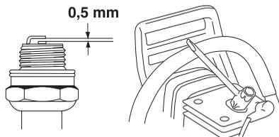
Observe! Use sempre o tipo de vela de ignição recomendado! Uma vela de ignição incorrecta pode danificar o pistão/cilindro. Verifique se a vela de ignição não produz interferências de rádio.
