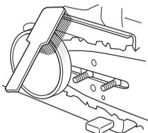
Controle periodicamente se restam pelo menos 0,6 mm da espessura da cinta nas partes de maior desgaste.
