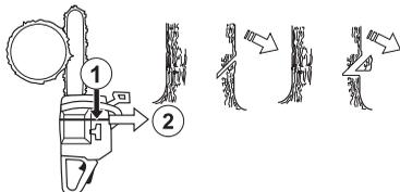
La profundidad del corte de indicación debe ser igual a  $1/4$  del diámetro del tronco, y el ángulo entre los cortes superior e inferior debe ser de  $45^\circ$  como mínimo.
