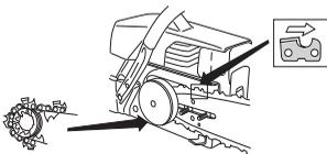
Verifique se o fio dos elos de corte está voltado para a frente, na parte superior da lâmina.
