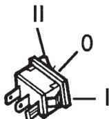
O interruptor está desligado na posição "0", fornece corrente ao aquecimento dos punhos na posição "I", fornece corrente ao aquecimento do carburador na posição "II".
