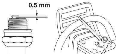
Aclaración! ¡Utilice siempre el tipo de bujía recomendado! Una bujía incorrecta puede arruinar el pistón y el cilindro. Asegúrese de que la bujía tenga supresión de perturbaciones radioeléctricas.
