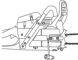
La cadena está correctamente tensada cuando no cuelga en la parte inferior de la espada y puede girarse fácilmente con la mano. Apriete las tuercas de la espada con la llave combinada, sujetando al mismo tiempo la punta de la espada.
