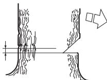
Coloque o apoio para casca (se estiver montado) atrás da linha de ruptura. Serre com aceleração total e deixa a corrente/lâmina penetrar devagar na árvore. Observe se a árvore se move no sentido contrário ao da direcção de queda pretendida. Introduza uma cunha de abate ou barra extractora logo que a profundidade de corte o permita.
