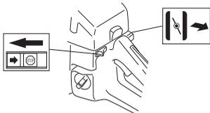
Se a máquina estiver equipada com uma válvula descompressora (A): Comprima a válvula para diminuir a pressão no cilindro, o que facilita o arranque da máquina. A válvula descompressora deve usar-se sempre no
