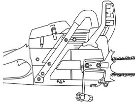
A corrente está correctamente esticada quando não mais estriver frouxa na parte inferior da lâmina e ainda possa ser girada facilmente com a mão. Aperte bem as porcas da lâmina com a chave universal ao mesmo tempo que segura a extremidade da lâmina.
