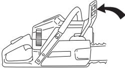
Desatarraxe inteiramente as porcas e remova a cobertura de acoplamento (travão de corrente). Retire o protector para transporte (A).
