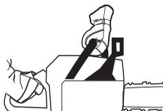
Acelere ao máximo e active o travão de corrente, virando o pulso esquerdo contra a protecção anti-retrocesso. Não solte o punho dianteiro. **A corrente deverá parar imediatamente.**
