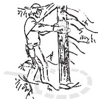
Remova a vegetação do solo em volta da árvore e prepare-se para eventuais obstáculos (pedras, galhos, buracos, etc.) de modo que possa fugir facilmente quando a árvore começar a cair. O caminho de fuga deve estar situada a cerca de 135° diagonalmente para trás da direcção de abate planeada para a árvore.
