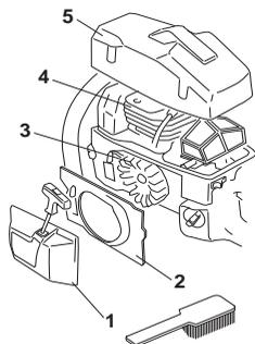
Limpe o sistema de arrefecimento com uma escova, uma vez por semana, ou com mais frequência, em condições de trabalho difíceis. O sistema de arrefecimento obstruído ou sujo conduz a um sobreaquecimento da máquina, danificando o cilindro e o pistão.
