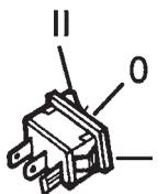
El interruptor está desactivado en la posición "0", entrega corriente para calefacción de los mangos en la posición "I", y entrega corriente para calefacción del carburador en la posición "II".
