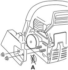
Monte a lâmina nos seus parafusos. Coloque a lâmina na sua posição mais atrás. Ponha a corrente sobre o pinhão e a ranhura da lâmina. Comece pela parte superior da lâmina.
