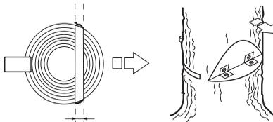
Perde-se todo o controlo sobre a direcção de queda da árvore se a linha de ruptura for demasiado pequena ou muito serrada, ou se o corte direccional e o corte de abate estiverem incorrectamente posicionados.
