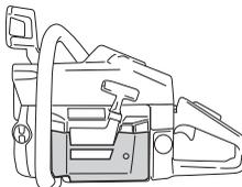
**NOTA!** Se estiver montado o conjunto kit de inverno ou se foram tomadas as medidas para aumento de temperatura, deve retornar-se a uma regulação normal quando a máquina for usada sob condições normais de temperatura. Caso contrário, há risco de sobreaquecimento com sérios danos para o motor.
