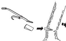
Recomendamos o uso de um comprimento de lâmina superior ao diâmetro do tronco na copa da árvore, de modo que o corte de abate e o corte direccional possam ser executados com o chamado 'corte simples'. Ver o capítulo Especificações técnicas com relação ao
