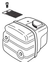
O silenciador é configurado para abafar o nível de ruído e para conduzir os gases de escape para longe do utilizador. Os gases de escape são quentes e podem conter faíscas que podem causar incêndios, se os gases forem dirigidos contra um material seco e inflamável.
