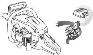
¡IMPORTANTE! Para que la depuración centrífuga funcione satisfactoriamente, debe efectuarse un mantenimiento constante del sistema. Limpie la toma de aire del mecanismo de arranque, las palas de ventilador del volante, el espacio alrededor del volante, el tubo de admisión y el compartimiento del carburador.
