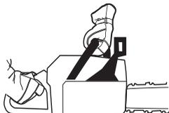
Acelere al máximo y active el freno de cadena girando la muñeca izquierda hacia la protección contra reculadas.
