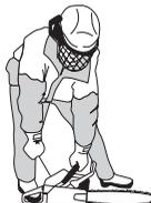
Cuando el motor encienda, oprima inmediatamente el estrangulador y repita los intentos de arranque hasta que el motor se ponga en marcha. Cuando arranque el motor, acelere al máximo y se desacoplará automáticamente la aceleración de arranque.
