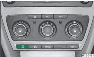
Fig. 138 Sistema ESP: Botão para o Sistema de Controlo de Tração (ASR)
