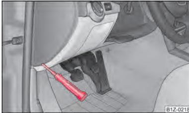
Fig. 176 Tampa dos fusíveis: Lado esquerdo do painel de instrumentos
