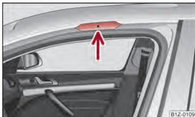
Fig. 66 Pontos de fixação para porta-bagagens de tejadilho
