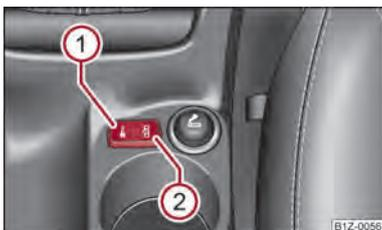
Fig. 13 Consola central: Botão do fecho centralizado
