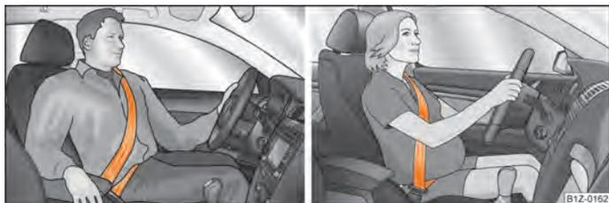
Fig. 119 Posicionamento da correia do cinto sobre o ombro e a bacia / Posicionamento da correia do cinto para senhoras grávidas
