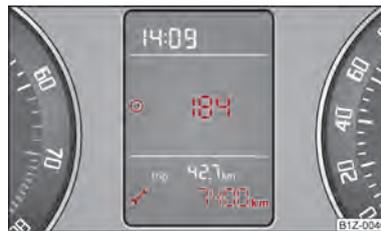
**Fig. 3** Indicação do intervalo de inspecção: **Aviso**
