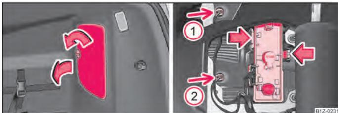
Fig. 189 Compartmento de carga: Tampa do suporte de lâmpada / Desmontagem do suporte de lâmpada
