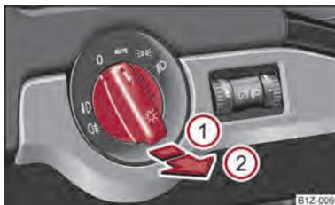
**Fig. 26** Quadro dos instrumentos: Interruptor da luz
