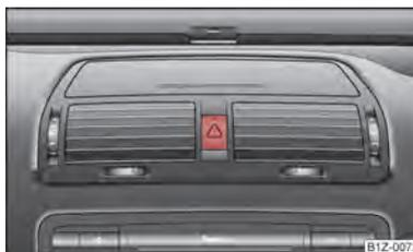
Fig. 29 Quadro dos instrumentos: Interruptor para a instalação de pisca-pisca de emergência
