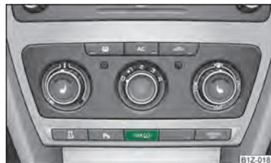
Fig. 140 Tecla para ajustar o valor de controlo da pressão de ar dos pneus
