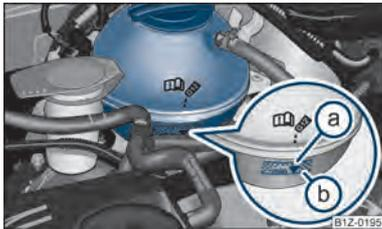
Fig. 152 Compartimento do motor: Vaso de expansão do líquido de refrigeração
