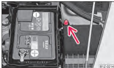
Fig. 172 Auxílio de arranque em veículos com sistema START-STOP
