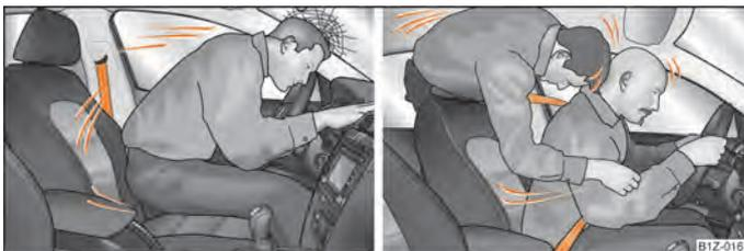
Fig. 118 O conductor sem cinto de segurança é projectado para a frente / O passageiro sem cinto de segurança no banco traseiro é projectado para a frente
