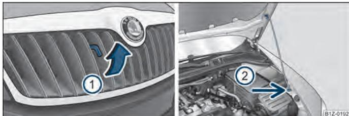
Fig. 149 Grelha do radiador: Alavanca de segurança / Segurança do capot com a vareta de apoio
