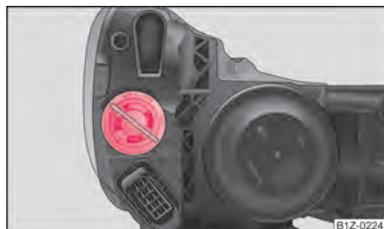
Fig. 182 Desmontagem da lâmpada para o pisca-pisca à frente
