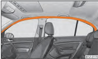
Fig. 127 Local de montagem do airbag para a cabeça
