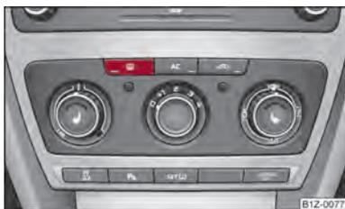
Fig. 34 Interruptor para o aquecimento do vidro traseiro
