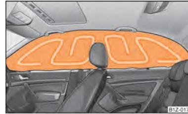
Fig. 128 Airbag para a cabeça cheio com gás
