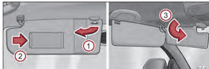
Fig. 35 Pala para sol: rodar para fora / dupla pala de sol
