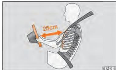
Fig. 124 Distância segura para o volante
