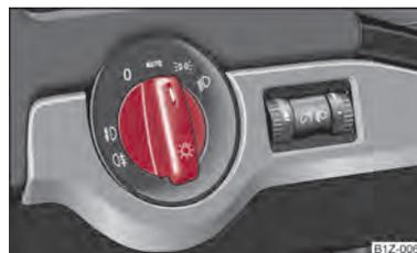
Fig. 25 Quadro dos instrumentos: Interruptor da luz
