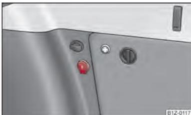
Fig. 74 Compartimento de carga: Tomada
