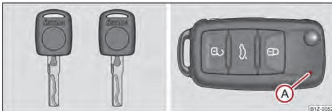
Fig. 9 Conjunto de chaves sem controlo remoto / Chaves com controlo remoto
