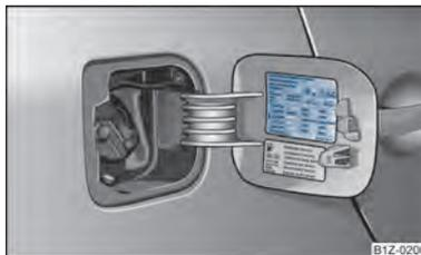
Fig. 157 Tampa do depósito aberta com uma tabela com as dimensões e os valores de pressão de ar dos pneus.
