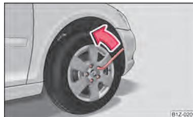
Fig. 166 Troca de rodas: Desapertar os parafusos da roda
