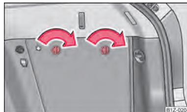
Fig. 161 Localização do triângulo de sinalização de emergência (Combi)
