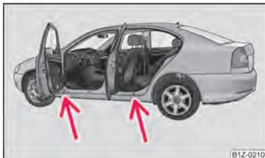
Fig. 167 Troca de rodas: pontos de aplicação do macaco
