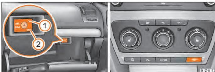
Fig. 129 Compartimento: Interruptor para o airbag frontal do passageiro dianteiro / luz de controlo para a desactivação do airbag do passageiro dianteiro.
