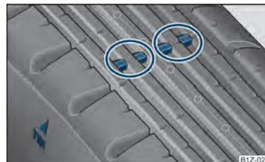
Fig. 158 Perfil dos pneus com indicador de desgaste
