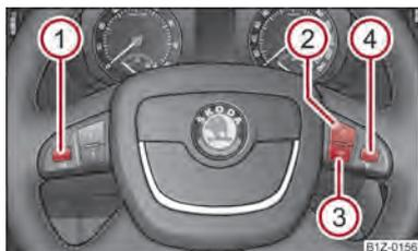
Fig. 113 Volante multifuncional: Botões de comando para o telefone
