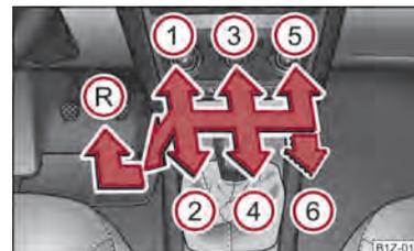
Fig. 100 Esquema de comutação: Caixa de velocidades de 5 ou 6 velocidades
