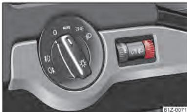
Fig. 28 Quadro dos instrumentos: Regulação do alcance das luzes
