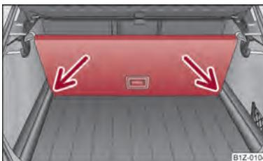
Fig. 61 Compartimento de carga: dividir a bagageira com o piso de carga variável
