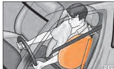
Fig. 126 Airbag lateral cheio de gás
