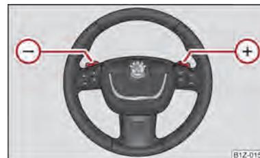
Fig. 108 Volante multifuncional: comutação manual
