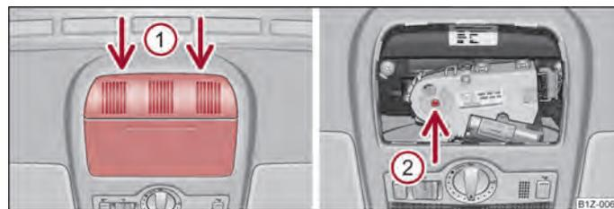
Fig. 23 Detalhe do tecto: Pontos de colocação da chave de fendas / Abertura para colocação da chave
