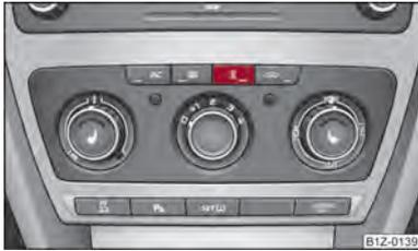
**Fig. 96** Botão para ligar/desligar directamente o aquecimento auxiliar (aquecimento e ventilação estacionários) na unidade de comando do ar condicionado
