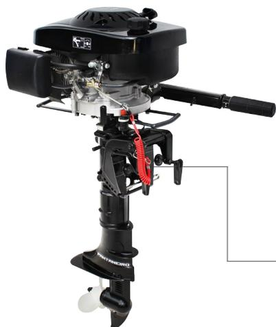
Instale o motor no centro do espelho da popa apertando firmemente os manípulos de fixação. Durante a navegação, certifique-se de que os manípulos não estejam soltos, o que pode resultar na queda do motor na água. Por precaução, recomendamos passar uma corda pelo orifício do suporte de fixação e amarrá-lo ao barco.
