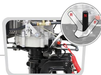
2. Ajuste o parafuso de fricção da coluna para evitar que o motor fique girando.
