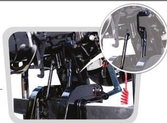
2. Ajuste o parafuso de fricção da coluna para posição original
