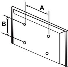
Instale o suporte em uma parede sólida e perpendicular ao chão.
