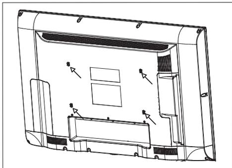
2. Instale o suporte de fixação na parede seguindo as instruções fornecidas com o suporte.
