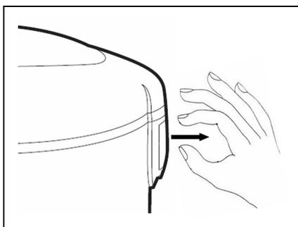
\* O coletor de água armazena a água proveniente do vapor da tampa.
