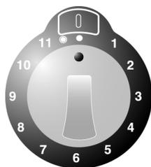
Alguns botões têm uma posição de **aquecimento suplementar (placa com elemento aquecedor duplo)**. Para activar esta, girar o botão do regulador de energia para a posição ●.
