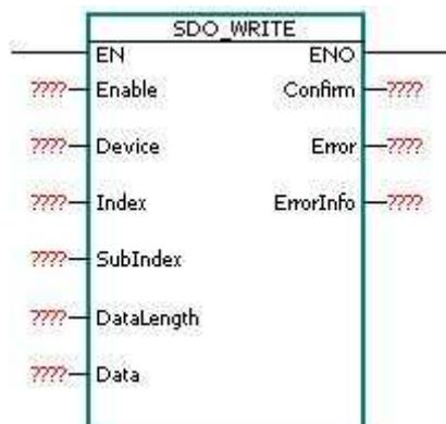
A instrução é usada para escrever objetos CANopen em um dispositivo específico, através de mensagens SDO.
