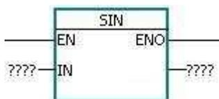
Quando a entrada EN for habilitada, será realizado o cálculo do seno de IN. O resultado é colocado na saída da função.
