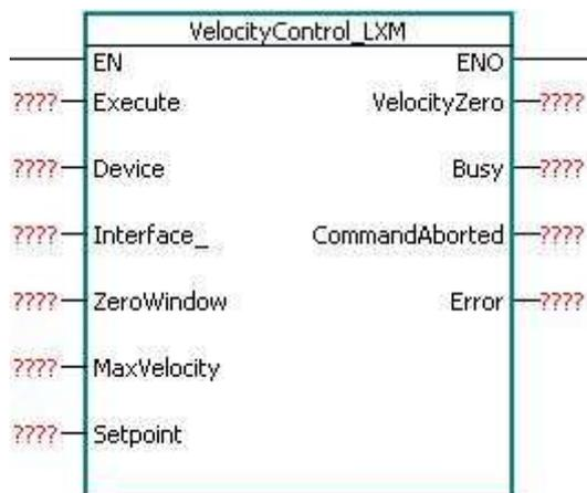
Com EN habilitado a instrução controla a velocidade do motor através do dispositivo indicado na entrada Device, quando ocorrer a transição de 0 para 1 (Borda de subida) na entrada Execute.
