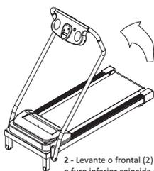
2 - Levante o frontal (2) lentamente até que o furo inferior coincida com o furo da chapa do Chassi(1). Conf. figura ao lado.
