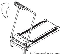
4 - Com auxílio de uma faca ou alicate corte as presilhas que seguram o monitor copo(15), solte os parafusos (37). Levante conf. figura, alinhando os furos do monitor com os furos do frontal.
