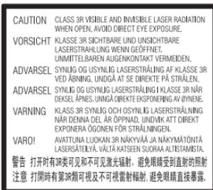
A unidade de leitura deste aparelho está classificada como equipamento CLASS 3R LASER. É emitida radiação laser visível e invisível quando a cobertura de proteção do laser está aberta, por isso, evite a exposição direta da vista.
