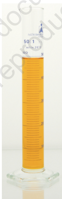
Figura 3 - Proveta de vidro
