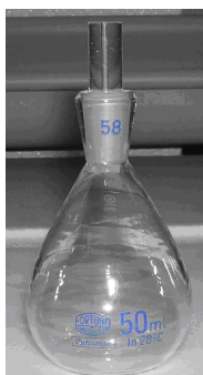
Figura 6 - Picnómetro de vidro
