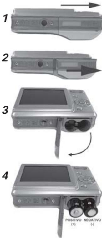
1. Pressione e deslize a Tampa do **Compartimento da Pilhas** no sentido indicado.
