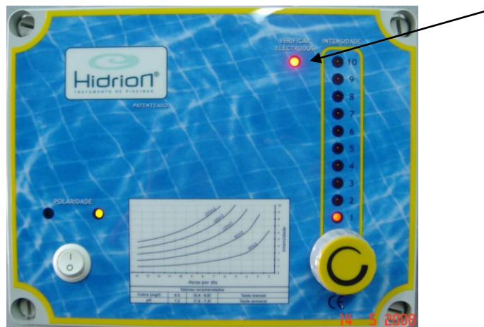
Luz Indicadora da necessidade de Verificação/Substituição de Eléctrodos
