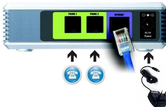
Nela identificamos as duas portas (em verde) destinadas à conexão com telefones ou troncos analógicos de PABX, através de um cabo de telefone padrão com conector RJ-11. A porta Internet (em azul) é destinada a receber a conexão Internet vinda de um *modem* ou roteador também através de um cabo de rede padrão com conector RJ-45.
