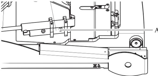
O cilindro de amortecimento (A) contém molas de pressão com alta tensão prévia. A abertura inadequada constitui perigo de acidente!
