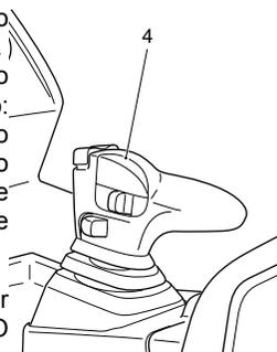
**Instalação hidráulica:** Grupo de bombagem com motor trifásico e bomba de alta pressão e precisão silenciosa. O comando da instalação é efectuado através do multi-piloto (4).
