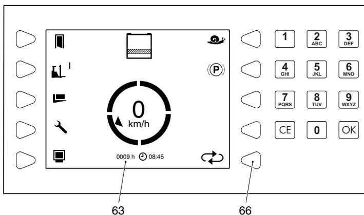
Se uma bateria for descarregada até ao estado de descarga permitido, o símbolo da bateria fica vazio.
