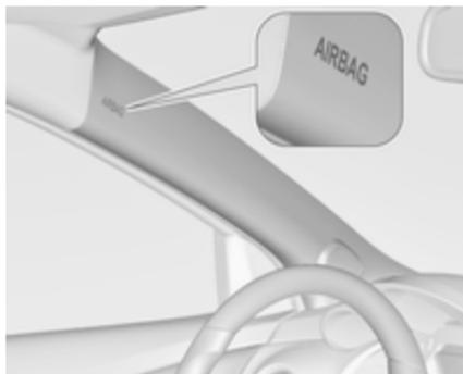
O sistema de airbags de cortina é composto por um airbag montado na estrutura das janelas, um de cada lado. Este pode ser identificado pela palavra **AIRBAG** nos pilares do tejadilho.
