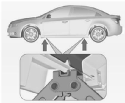
4. Certificar-se de que o macaco está bem colocado nos pontos de elevação com macaco do veículo.
