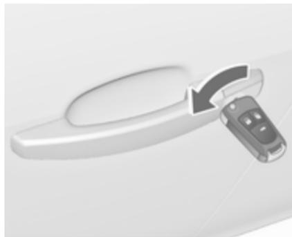
Destrancar manualmente a porta do condutor rodando a chave na fechadura. Ligar a ignição e pressionar o botão do fecho centralizado
