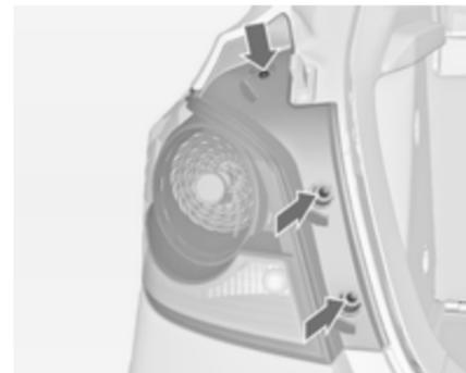
2. Desapertar os três parafusos.
