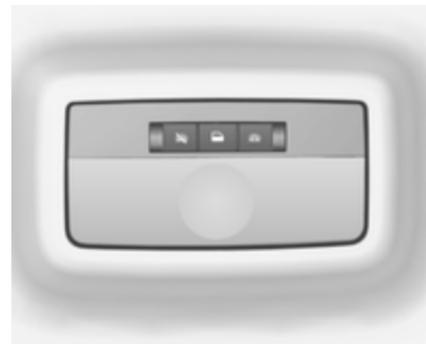
Durante a entrada e saída do veículo, as luzes de cortesia acendem automaticamente e depois apagam passado algum tempo. Acende-se brevemente mesmo se a chave for retirada da fechadura da ignição.
