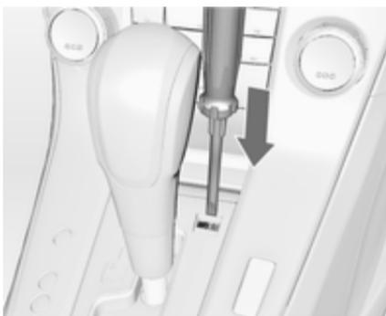
3. Inserir uma chave de parafusos na abertura até onde avançar e deslocar a alavanca para fora do **P**. Se **P** for novamente engatada, a alavanca selectora ficará novamente bloqueada. Reparar a causa da interrupção de alimentação eléctrica numa oficina.
