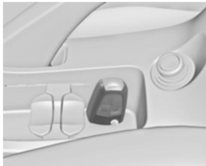
Abrir a tampa na parte de baixo do suporte para copos na consola central. Extrair a chave electrónica e inseri-la no canhão da chave.
