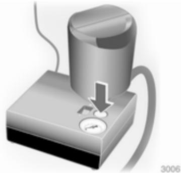
Se a pressão de pneu prescrita não for atingida no espaço de 10 minutos, retirar o kit de reparação de pneus. Deslocar o veículo de forma a que o pneu dê uma volta completa. Voltar a ligar o kit de reparação de pneus e continuar o procedimento de enchimento durante 10 minutos. Se se continuar a não atingir a pressão do pneu prescrita, o pneu está muito danificado. Recorrer à ajuda de uma oficina.
