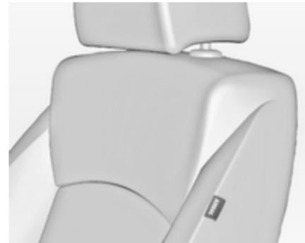
O sistema de airbags laterais é composto por um airbag em cada um dos encostos dos bancos dianteiros. Este airbag pode ser identificado pela palavra **AIRBAG**.
