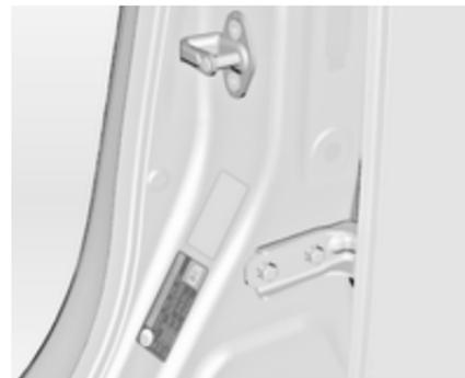
Pressão dos pneus ⇨ 341 e na etiqueta na estrutura da porta do condutor.
