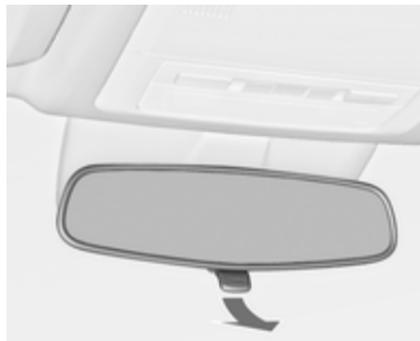
Para reduzir o encandeamento, puxar a alavanca na parte inferior da caixa do espelho retrovisor.
