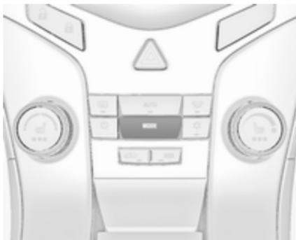
Pressionar uma vez o botão **MODE** ou repetidamente para obter o ajuste desejado, a definição da distribuição do ar é indicada no visor de informações.
