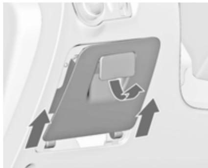
A caixa de fusíveis encontra-se atrás do compartimento de arrumação no painel de instrumentos.
