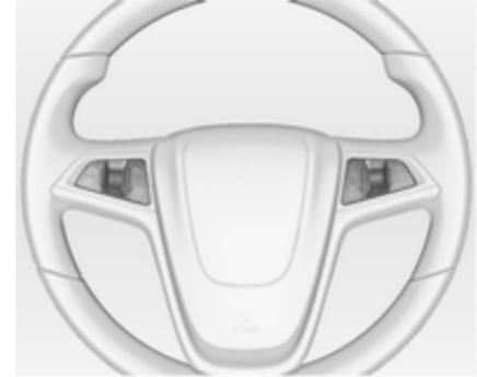
O sistema de informação e lazer e comando de velocidade de cruzeiro podem ser accionados utilizando os comandos no volante.
