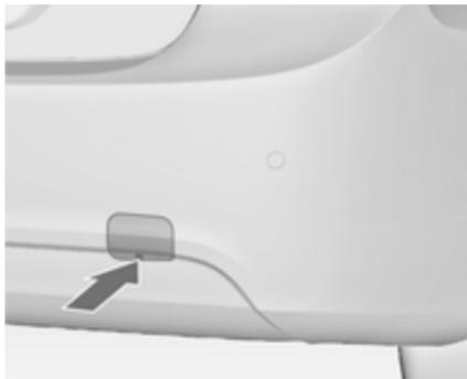
Desencaixar a tampa ao pressionar a marca e remover a tampa.
