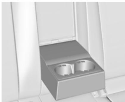
Dobre o apoio para o braço para baixo puxando na cinta. O apoio para o braço dobrado inclui um suporte para bebidas.
