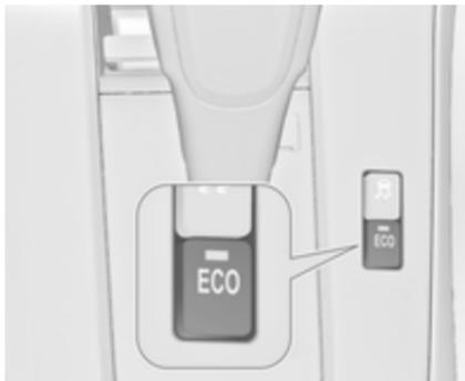
Desactivar manualmente o sistema Start/Stop carregando no botão **ECO**. A desactivação é indicada quando o LED no botão se apaga.
