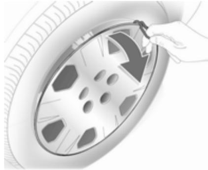
1. Desencaixar as tampas dos parafusos das rodas com uma chave de parafusos e retirar. Retirar o tampão da roda com o gancho. Ferramentas do veículo
