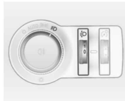
Para adaptar o alcance dos faróis à carga do veículo, para evitar encandeamento: rodar o botão de accionamento manual
