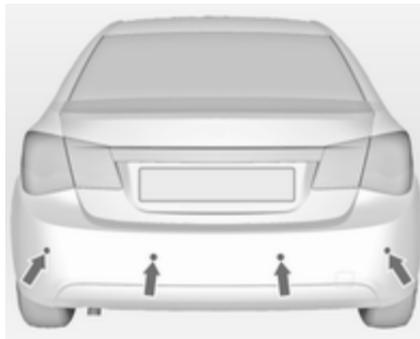
A assistência no estacionamento facilita o estacionamento medindo a distância entre o veículo e os obstáculos à retaguarda emitindo sinais acústicos. É no entanto o condutor que continua totalmente responsável pelo acto de estacionar.
