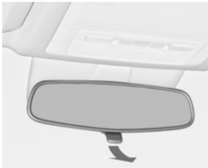
Ajustar a alavanca na parte inferior para reduzir o encandeamento.
