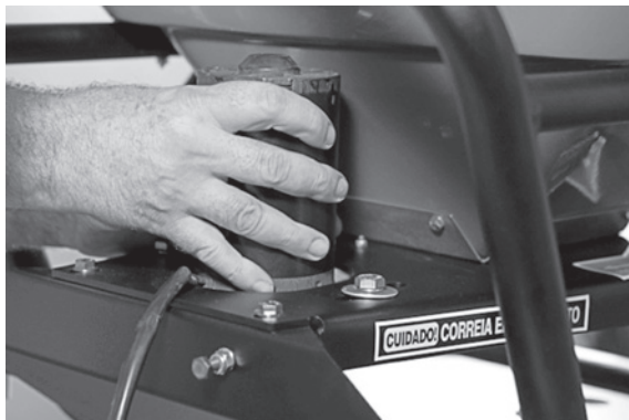
4º Passo: Movimentar o motor para soltar a correia
