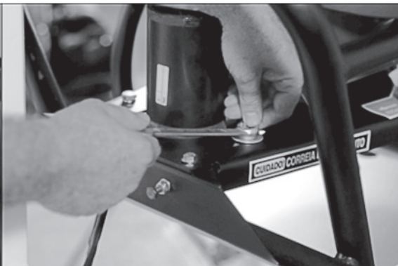
17º Passo: Movimentar o motor tensionando a correia
