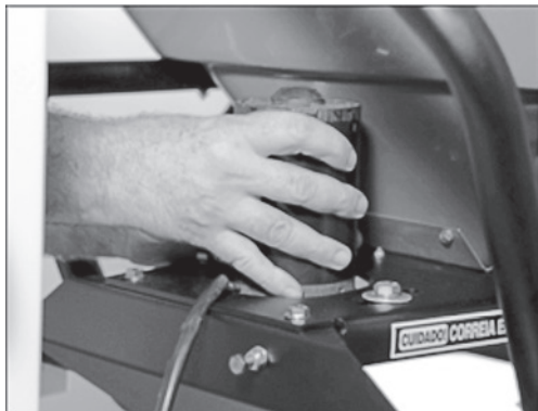
17º Passo: Movimentar o motor tensionando a correia
