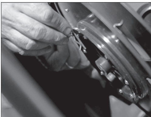
6º Passo: Retirar a trava e o disco lançador
