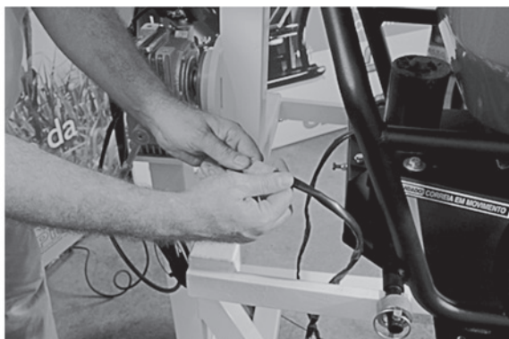
18º Passo: Reconectar o cabo que liga o controlador de velocidade ao motor elétrico
