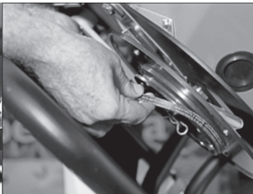
5º Passo: Retirar a correia do disco e do motor
