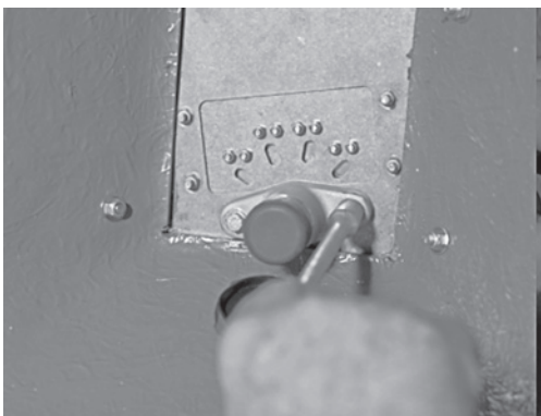
7º Passo: Retirar o mancal. Utilize a chave "L" de 10 milímetros
