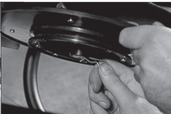
14° Passo: Encaixar o disco no eixo do mancal. Observar que o rolamento do disco lançador deve se encaixar entre as abas do vibrodosador. Somente depois colocar a trava.
