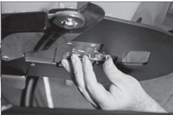
11° Passo: Substituir o vibrodosador
