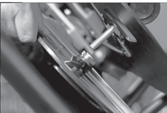
6º Passo: Retirar a trava e o disco lançador
