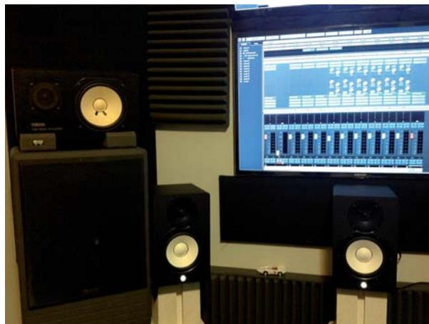
Fig. 2 - Sistemas de monitoração. Monitores Left e Monitor central do 5.1
