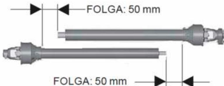
Antes de cortar o cardan, verifique se existe uma possibilidade de usá-lo no tamanho original, caso não haja, marque no cardan os pontos que deverá ser cortado, retire-o da máquina e do trator e corte-o.
