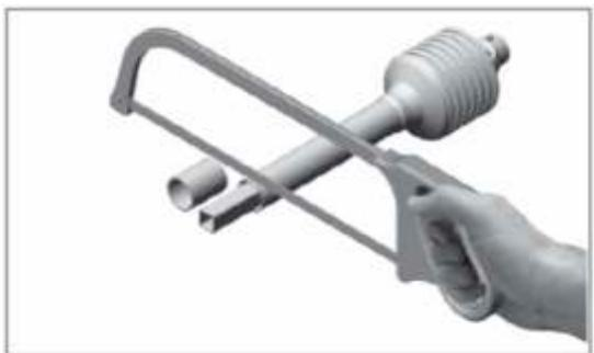
Os pedaços que serão cortados deverão ser do mesmo tamanho. Após o corte passe uma lima nas partes serradas para um melhor acabamento. Lubrifique com uma pequena camada de graxa, encaixe as partes mantendo os garfos alinhados conforme figura abaixo. Caso ficar desalinhado, vai causar vibrações excessivas e danificar mais rapidamente os componentes.
