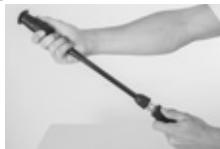
Montagem da ponteira
