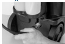
Montagem da mangueira na lavadora
