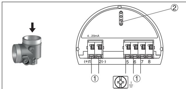
Fig. 3: Compartimento do sistema eletrônico da caixa de duas câmaras
