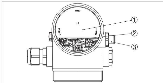
Fig. 6: Vista do compartimento do sistema eletrônico com DISADAPT para a conexão da unidade externa de visualização e configuração
