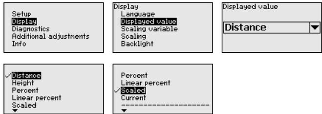
O ajuste de fábrica para o valor de exibição é, por exemplo, distância para sensores de radar.
