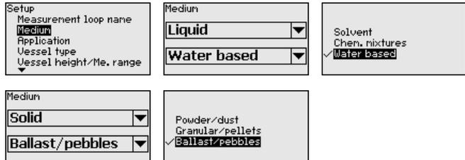
Essa seleção permite o ajuste ideal do sensor ao produto e à segurança de medição é aumentada significativamente, principalmente no caso de material com baixa propriedade de reflexão.
