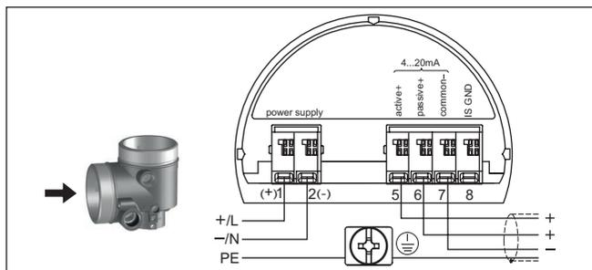
Fig. 4: Compartimento de conexão da caixa e duas câmaras para tensão da rede
