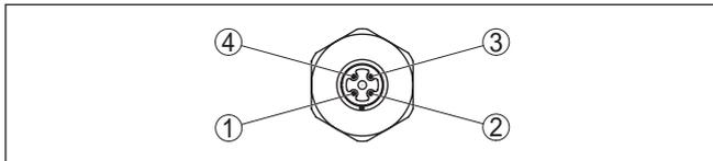
Fig. 7: Vista do conector de encaixe M12 x 1
