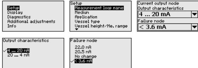
O ajuste de fábrica é a curva característica da saída 4 ... 20 mA, o modo de falha < 3,6 mA.
