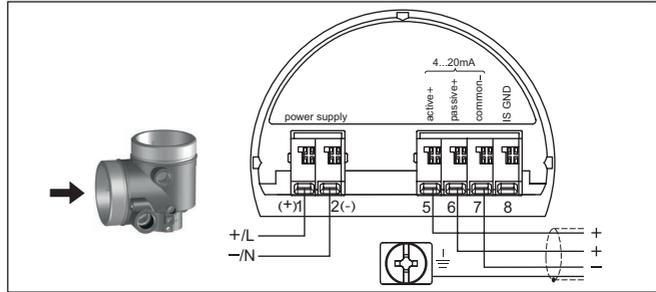
Fig. 5: Compartimento de conexão da caixa e duas câmaras para baixa tensão
