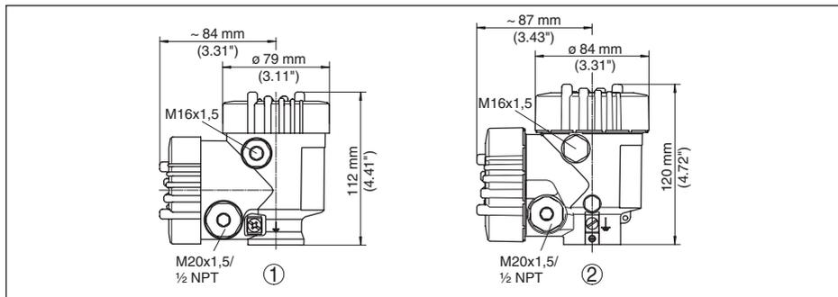
Fig. 18: Dimensões da caixa - com o módulo de visualização e configuração, a altura da caixa é aumentada em 9 mm/0.35 in
