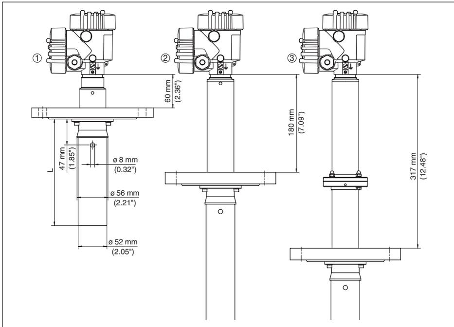
Fig. 19: VEGAPULS 66, Modelo com tubo vertical<sup>5)</sup>
