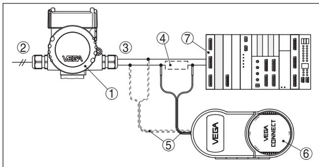
Fig. 13: Conexão do PC à linha de sinais via HART
