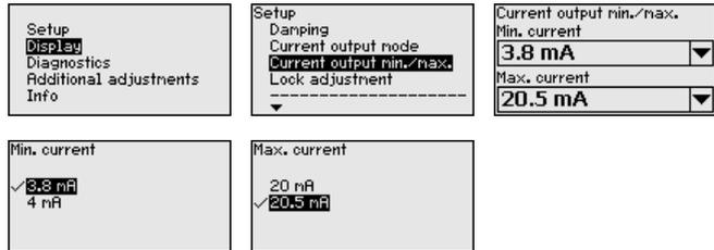
O ajuste de fábrica é corrente mín. de 3,8 mA e corrente máx. de 20,5 mA.
