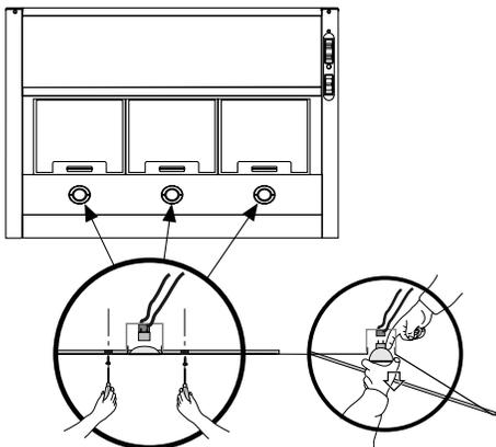
Avant de commencer, placer tous les commutateurs de la hotte à la position d'arrêt et vérifier que les lampes se sont suffisamment refroidies. La température de service d'une lampe à halogène est très élevée.
