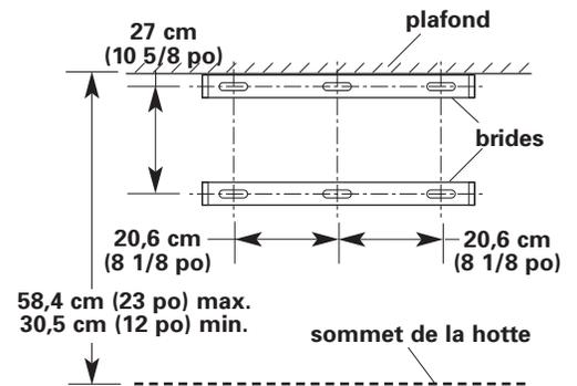
**Veiller à ce que les vis soient solidement fixées dans le mur.**
