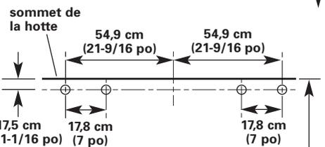
**5a. Installation de la garniture cache-conduit (option) :** Placer la garniture au sommet de la hotte; fixer avec les vis fournies. La garniture doit être fixée au sommet de la hotte avant l'installation de la hotte sur le mur.
