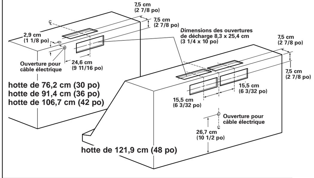
**5.** La hotte doit être fixée au mur avec les vis de montage conformément aux indications de l'illustration. Il y a deux vis de montage pour les modèles de 76,2 cm (30 po) et 91,4 cm (36 po). Il y a quatre vis de montage pour les modèles de 106,7 cm (42 po) et 121,9 cm (48 po). Visser chaque vis horizontalement dans le mur jusqu'à ce que la tête de vis soit bien serrée contre le mur.
