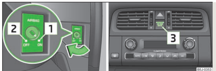
Fig. 106 Interruptor da chave para o airbag frontal do passageiro dianteiro / luz de controlo para a desactivação do airbag frontal do passageiro dianteiro
