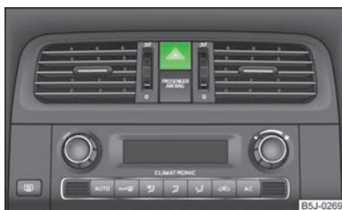
Fig. 24 Painel de bordo: interruptor de luzes de emergência
