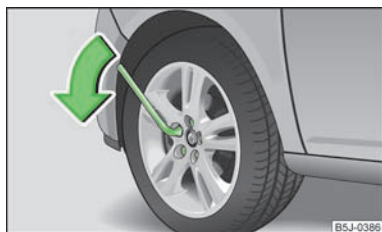
Fig. 133 Substituição da roda: Alivie os parafusos da roda
