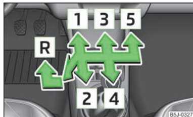
Fig. 82 Esquema de selecção da caixa manual de 5 velocidades
