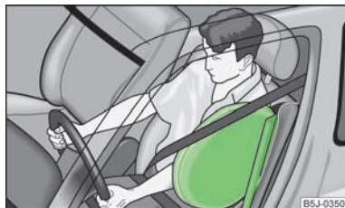
Fig. 103 Airbag lateral insuflado com gás
