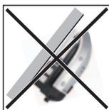
Não montar o inversor de forma suspensa com as conexões para baixo.
