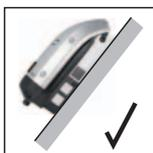
O inversor é adequado para a montagem em uma superfície inclinada.
