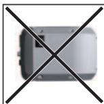
Não montar o inversor na posição horizontal em uma parede ou coluna vertical.
