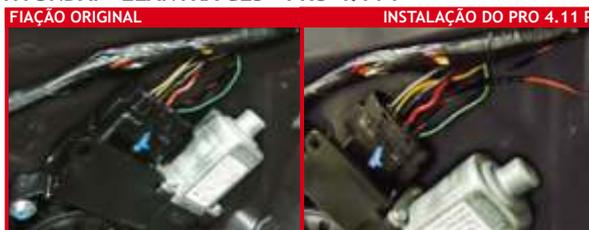
**ATENÇÃO:** No veículo Elantra cortar o fio PRETO/LARANJA localizado no conector do motor do vidro do motorista e ligar o fio LARANJA/PRETO do PRO4.11 P no sentido do motor. Isolar a outra ponta do fio.
