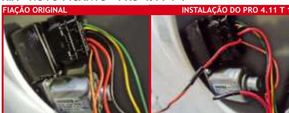
**ATENÇÃO:** No veículo Novo Picanto é necessário cortar o fio VERMELHO localizado no conector do motor do vidro do motorista e ligar o fio LARANJA/PRETO do PRO4.11 T 1 no sentido do motor. Isolar a outra ponta do fio.
