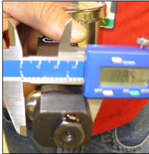
Figura 22 – Verificação da dimensão da área de compressão
