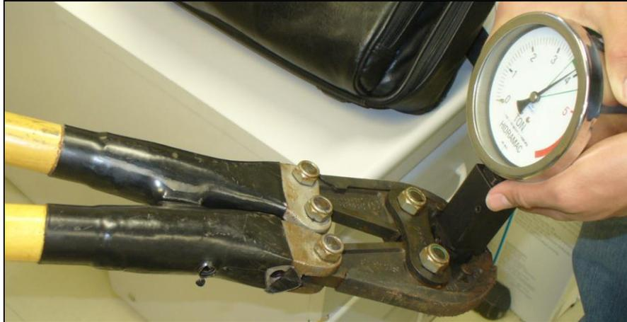
Figura 23 – Alicates MD-6 efetuando compressão na esfera do manômetro
