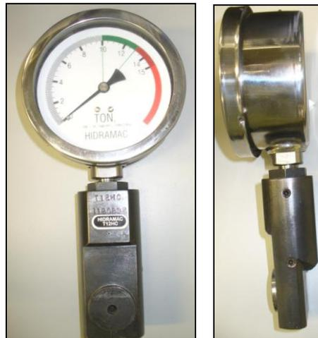
Figura 24 – Manômetro para ensaio do alicate de compressão hidráulica
