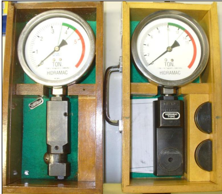
Figura 20 - À esquerda o manômetro usado para aferição do alicate mecânico e a direita o manômetro usado para aferição do alicate hidráulico
