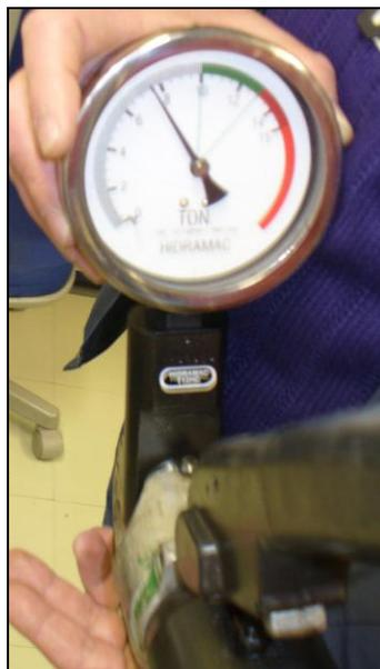
Figura 29 – Indicação de perda de pressão hidráulica
