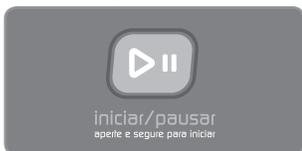
Ao tocar e manter pressionada por 3 segundos a tecla **iniciar/pausar**, você irá ouvir a porta travar, destravar e travar novamente. A porta da lavadora permanecerá travada durante o ciclo de lavagem.
