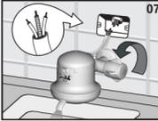
• Faça correr água pela torneira, antes de fazer a conexão à rede elétrica, para encher de água a câmara de aquecimento e evitar a queima da resistência. (fig. 07). Verifique se há algum vazamento. Feche o registro. Não conectar à torneira dispositivos que não estejam indicados neste manual.
