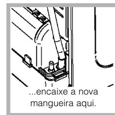
Encaixe uma extensão adequada da mangueira para a nova localização apresentada (*ver diagrama*).
