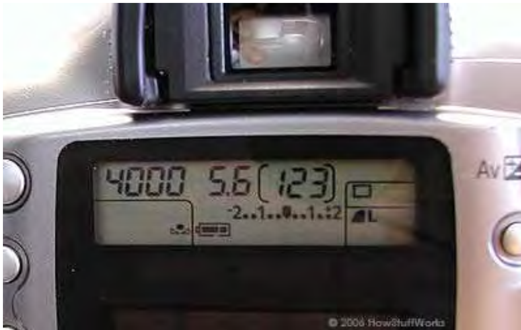
Visor LDC, das câmeras High Tech, indicações de velocidade abertura e fotometria em “EV=0”.
