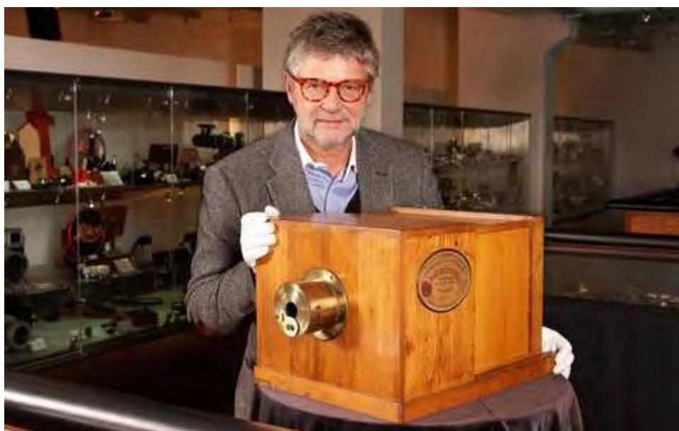
Colecionador e seu daguerreótipo. A traseira da câmera se movimentava, para focalizar a imagem
