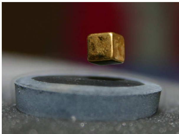
Figura 1.2: Ímã levitando sobre nitrogênio líquido refrigerado a temperatura de -200^{\circ}C [53].
