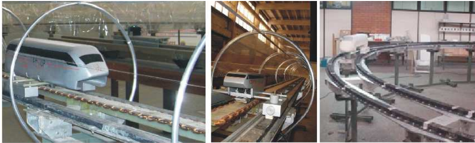
Figura 1.5: Linha em escala reduzida do protótipo MAGLEV Cobra, COPPE - UFRJ.
