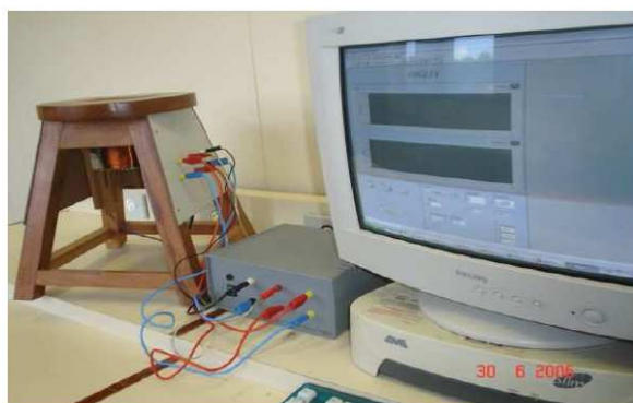
Figura 1.7: Protótipo MAGLEV construído na UFPA - Campus do Guamá [54].
