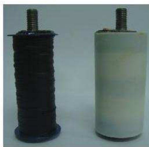
Figura 3.5: Bobinas construídas para a bancada.
