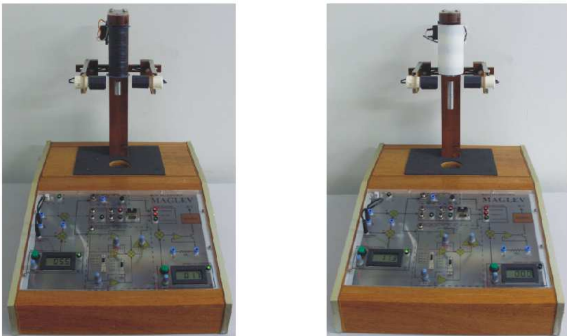
Figura 5.1: Bancada Didática MAGLEV em funcionamento.
