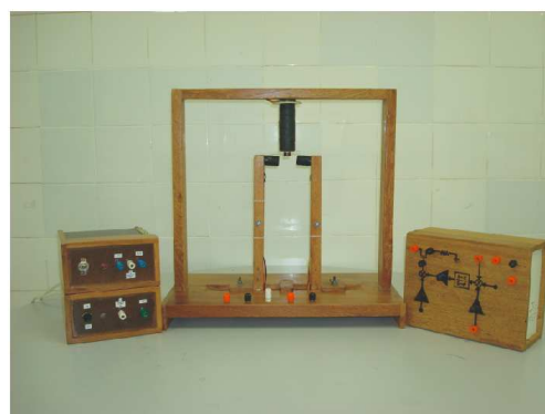
Figura 1.8: Protótipo MAGLEV construído na UFPA - Campus de Tucuruí [14, 42].
