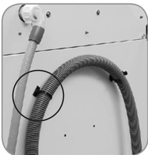
8. Instale a mangueira de saída de água no tanque ou em um tubo exclusivo para escoamento, com diâmetro de 5 cm. Para instalação em TANQUE, mantenha a curva plástica que acompanha a extremidade da mangueira. Para instalação em TUBO DE ESCOAMENTO, retire a curva plástica, empurrando a mangueira para dentro da curva plástica e, em seguida, para cima.
