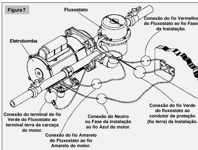
2- Conecte o terminal do **Fio Verde** do Fluxostato ao terminal **Terra** na carcaça da Eletrobomba. Conecte o outro **Fio Verde** do Fluxostato ao **Condutor de Proteção (Fio Terra)** de sua instalação.
