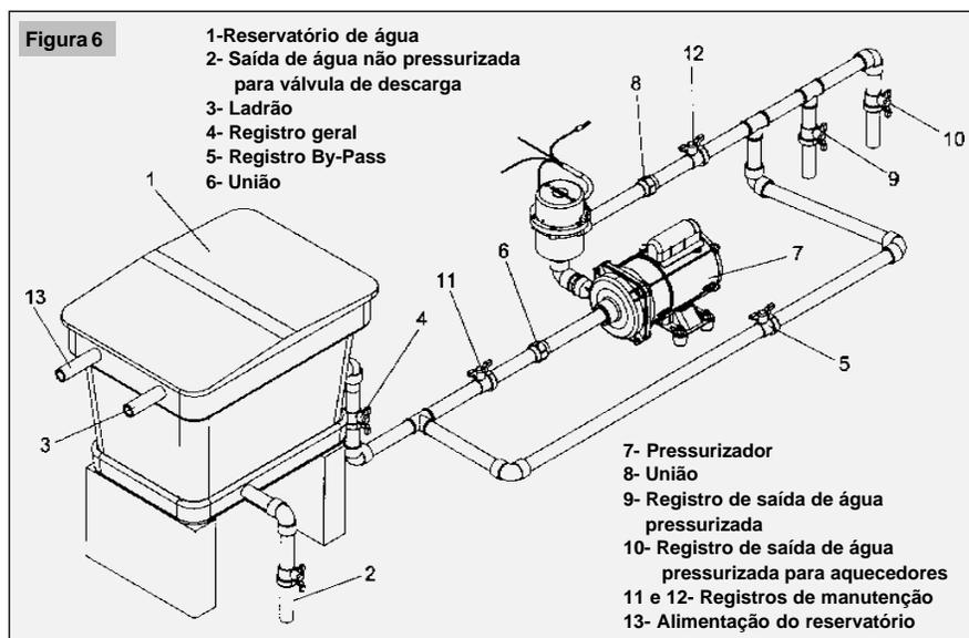
1- Apóie o Pressurizador em uma superfície plana e impermeável, deixando-o bem acomodado para melhor conexão das tubulações.
