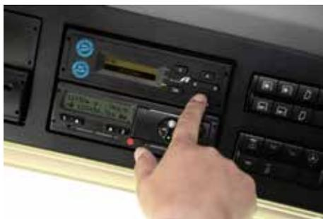
Quando a ignição estiver ligada, o condutor tiver verificado os dados e confirmado com “OK” e o LED verde estiver aceso na unidade de bordo, o sistema de portagem automático encontra-se ativado para o respetivo veículo. Para mais informações, consulte o
