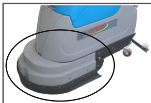
Visão geral do conjunto de proteção montado
