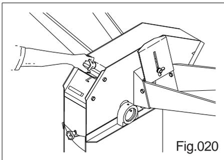
O milho a ser usado deveria estar seco ou com o teor de umidade de 20% no máximo. Fecha-se o registro de bica para verdes e abre-se o registro da bica para secos.
