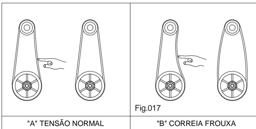
Para esticar a correia da polia de acionamento basta soltar os parafusos que fixam o mancal do esticador ("a" fig.018) e através do parafuso tensor conforme figura ("b" fig.018), faça o ajuste da correia conforme mostra a figura ("A"fig.017)
