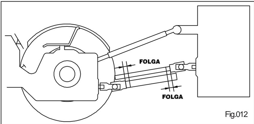
3- Após a determinação dos locais onde vão ser efetuados os cortes, encurte os tubos protetores interno e externo igualmente. Encurte os perfis deslizantes interno e externo no mesmo comprimento dos tubos protetores. Retire todas as pontas e rebarbas, e engraxe os perfis deslizantes.
