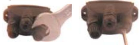
11° - Instale agora o cabo da solenóide no prensa cabos nº 3, repetindo os passos 6, 7 e 8. Caso o sensor não seja conectado a nenhuma solenóide, substitua o prensa cabos por um tampão PG 9 (cabos de 4 a 8mm) fornecido com o kit de terminais, repetindo o item 10.
