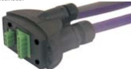
10.1 - Retire o prensa cabo nº 3 com a ajuda de uma chave de boca 19mm.
