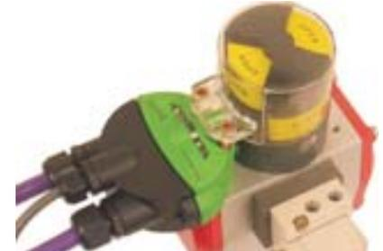
8° - Agora movimente o atuador, para tanto energize a válvula solenóide se esta estiver conectada pneumáticamente ao atuador, observe se a válvula não possui um botão de acionamento manual.
