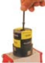
3° - Ajuste o indicador local girando-o com a mão de modo que o alvo metálico superior fique sob o sensor 1 e o alvo metálico inferior a 90°, observando o sentido em que o atuador irá girar, então aperte o parafuso de fixação do indicador local.
