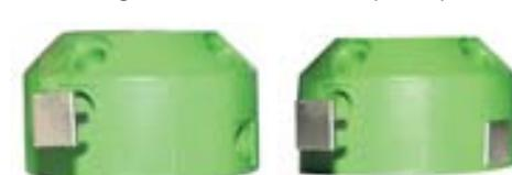
3° - Insira o outro alvo metálico na posição a 90° e observando o sentido em que o atuador pneumático irá girar.
