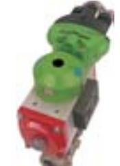
8° - verifique o funcionamento do conjunto sensor / atuador, para tanto conecte a alimentação do sensor conforme o seu diagrama de conexões, verificando o acionamento do led de alimentação.
