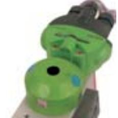
9° - com o sensor superior S1 acionado, ou seja com o alvo metálico posicionado na frente do sensor superior o seu respectivo led deve estar aceso.
