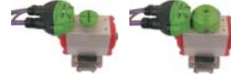
4° - agora instale o parafuso M6x25mm para a fixação do "copinho" ao eixo do atuador, não aperte em demasia.
