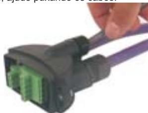
10° Instale agora o cabo da solenóide no prensa cabos nº 3, repetindo os passos 6, 7 e 8. Caso o sensor não seja conectado a nenhuma solenóide, substitua o prensa cabos por um tampão PG 9 (cabos de 4 a 8mm). Siga os passos abaixo:
