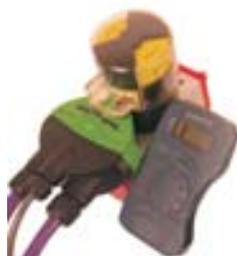
4º - Movimente a válvula para a posição fechada, o multímetro 2 na escala de resistência deverá indicar infinito.
