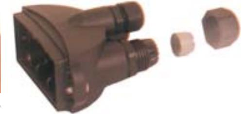
Recomendamos a utilização de cabos com diâmetro de 5 a 9 mm, para que o prensa cabos possa garantir a vedação da caixa de conexões.
