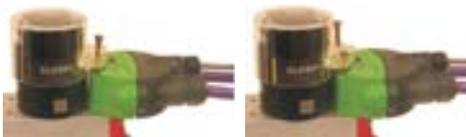
6° - Agora teste o funcionamento do conjunto sensor / atuador, para tanto conecte a alimentação do sensor conforme o seu diagrama de conexões, verificando o acionamento do led de alimentação.
