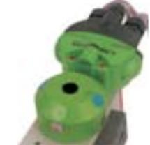
10° - Agora movimente o atuador, para tanto energize a válvula solenóide se esta estiver conectada pneumáticamente ao atuador, observe se a válvula não possui um botão de acionamento manual.
